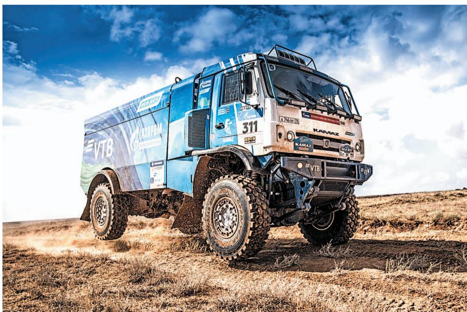
К ралли «Шелковый путь – 2018» командой «КАМАЗ-мастер» была изготовлена новая модификация газового «КАМАЗа» с двигателем 16,16 л и газовым оборудованием третьего поколения. Автомобиль успешно преодолел 7 этапов общей протяженностью около 3 500 километров.
