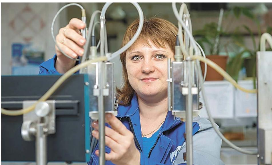
Тихоновой – отдельная тема. Рассказывает она о нем увлеченно, сразу видно, что хорошо разбирается. Одним из последних экземпляров, поступивших в лабораторию в 2017 году, является прибор для определения предельных температур фильтруемости дизельных топлив AirSTAR.
