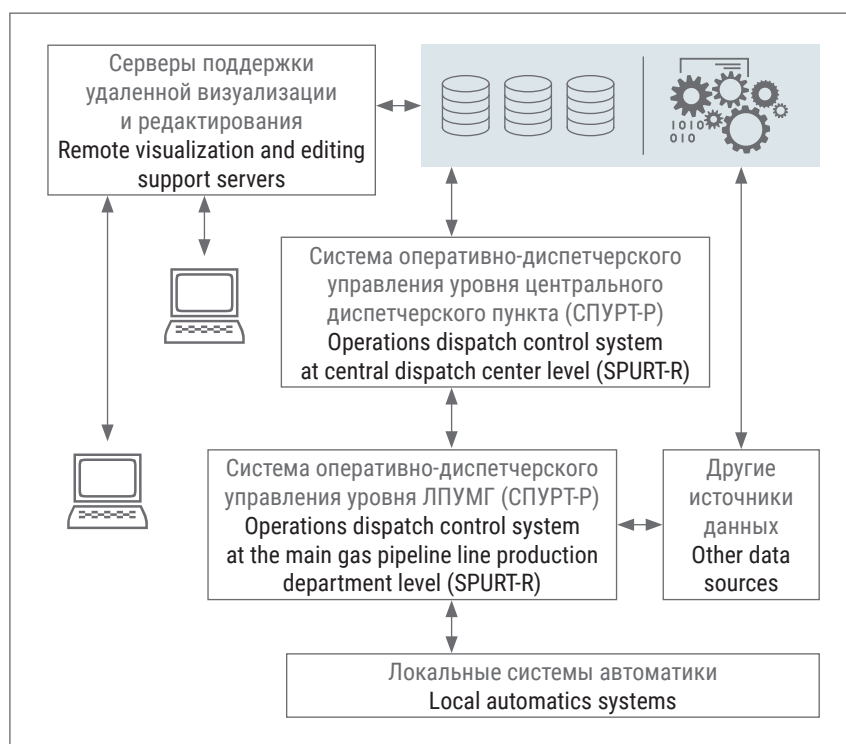
Рис. 7. Схема встраивания цифрового двойника в информационно-управляющую систему ООО «Газпром трансгаз Чайковский» Fig. 7. Diagram for digital twin integration into the management information system of Gazprom transgaz Tchaikovsky LLC
